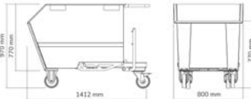
BENNA PORTAROTTAMI RIBALTABILE CAPACITÀ 500 L CON RUOTE PREDISPOSTA PER GRIGLIA E RUBINETTO
